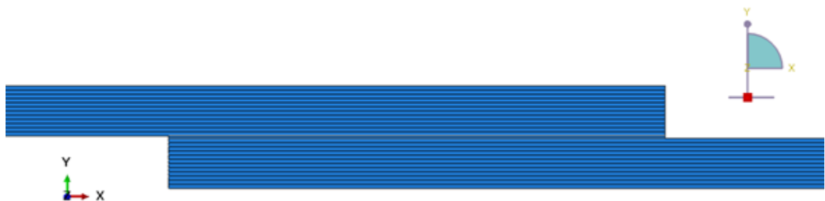
Figura 2.11: Disposição das camadas de carbono epóxi em cada aderente.
