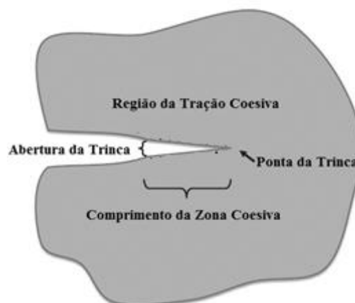
Figura 1.11: Região coesiva na abertura da trinca – HALLETT E HARPER (2015)
