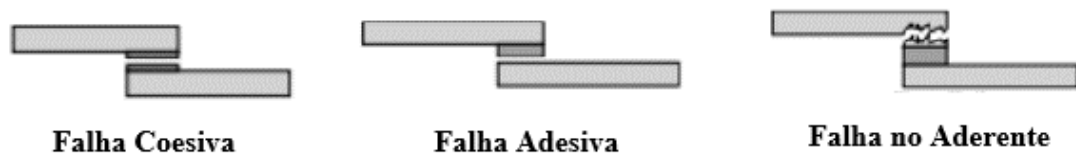
Figura 1.6: Tipos de falhas nas juntas coladas – NOORMAN (2014)
