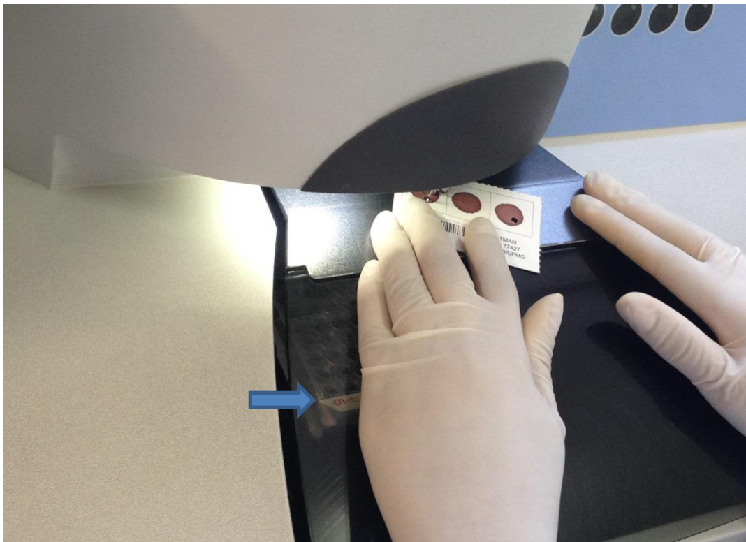
Figura 3: Sangue seco em papel filtro no picotador automático do Laboratório de Triagem Pré-Natal do NUPAD-UFMG e placa de ELISA abaixo (seta). O picote é depositado numa cavidade de placa específica, em posição determinada pelo esquema de placa gerado a partir da leitura de código de barras de identificação do papel filtro.
