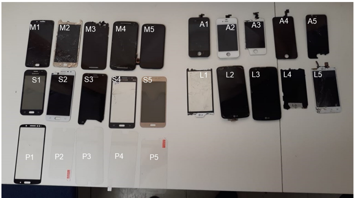
Figura 16 - Telas de smartphones da Samsung (S1-S5), Motorola (M1-M5), Apple (A1-A5), LG (L1-L5) e películas (P1-P5) utilizadas na aplicação do método.
