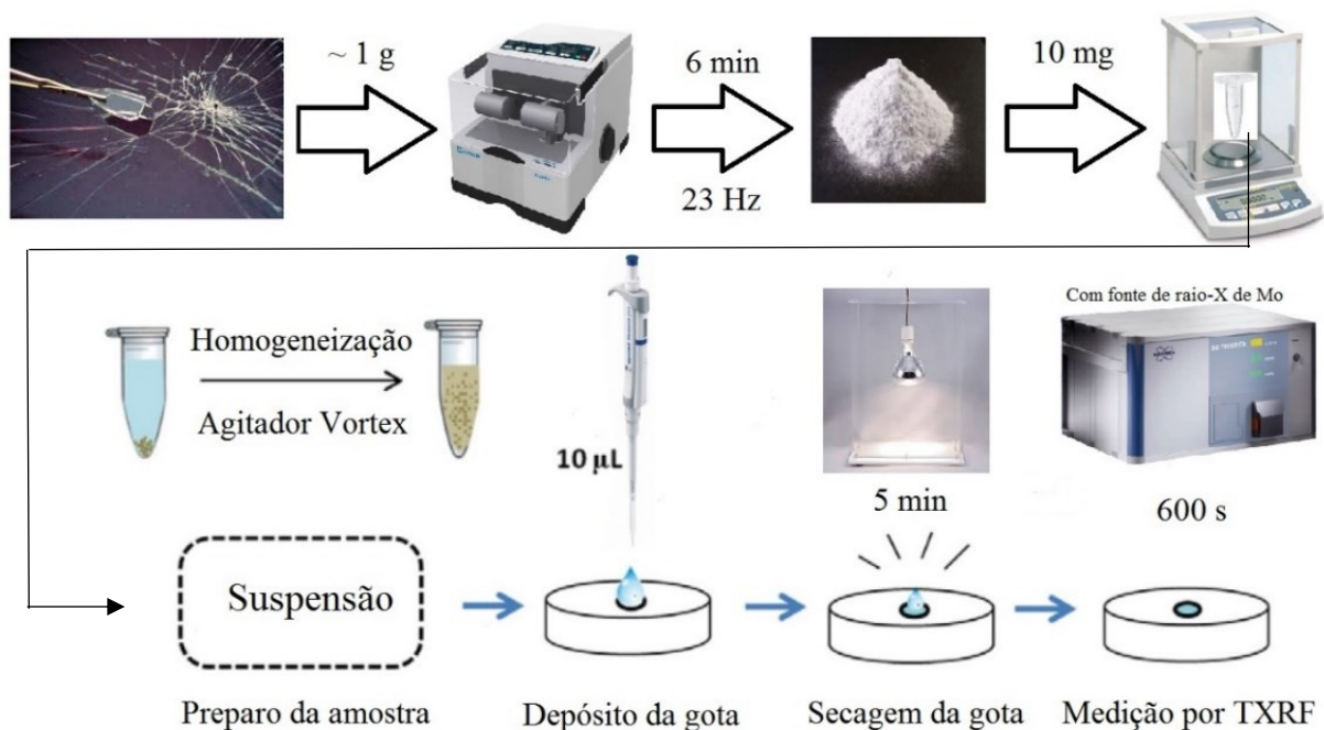
Figura 23 - Fluxograma do método proposto para a caracterização inorgânica de vidro por TXRF para fins forenses.
