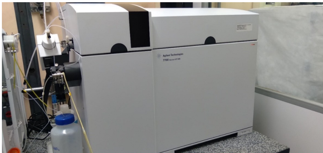
Figura 15 - Aparato instrumental de ICP-MS utilizado na comparação com método proposto
