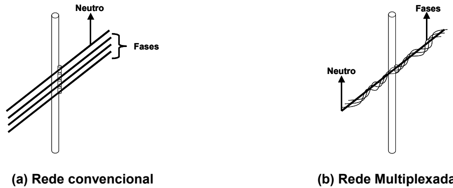
Figura 5.34 – Representação de configurações de rede de baixa tensão trifásica do tipo convencional e multiplexada.
