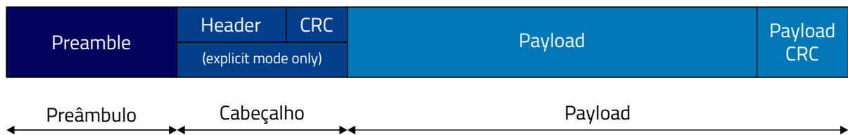
Figura 5 – Estrutura do pacote do transceptor LoRa.
