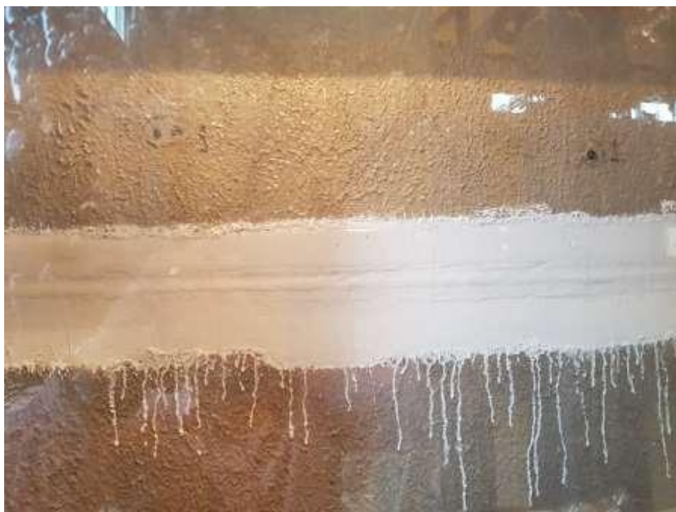
Figura 27: Face do painel recebendo a vazão de água após ensaio de calor e choque térmico. Fonte: LAEES – UFMG
