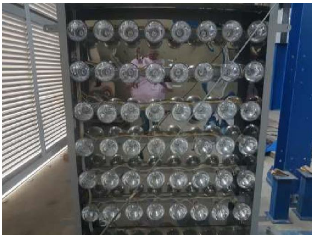
Figura 21: Painel de radiação para aquecimento da parede pré-fabricada. Fonte: LAEES – UFMG
