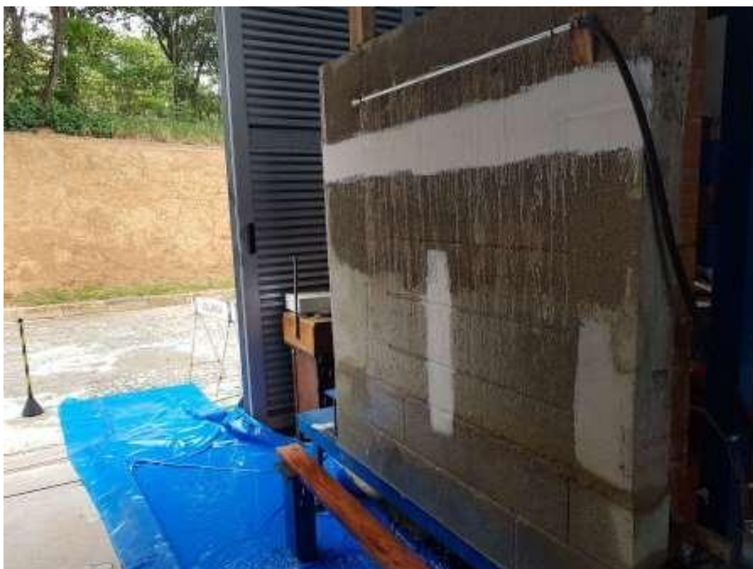
Figura 25: Resfriamento do painel com água. Fonte: LAEES – UFMG
