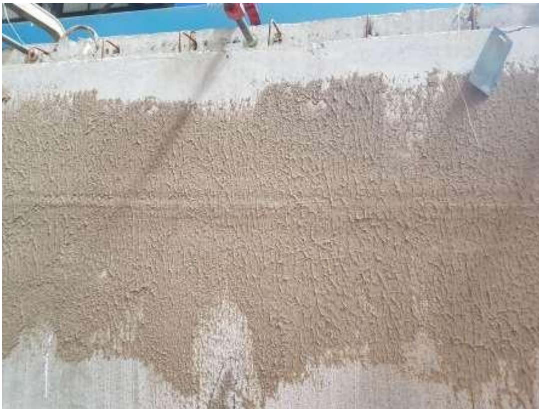
Figura 28: Face oposta do painel após o ensaio de estanqueidade e ensaio de calor e choque térmico. Fonte: LAEES – UFMG
