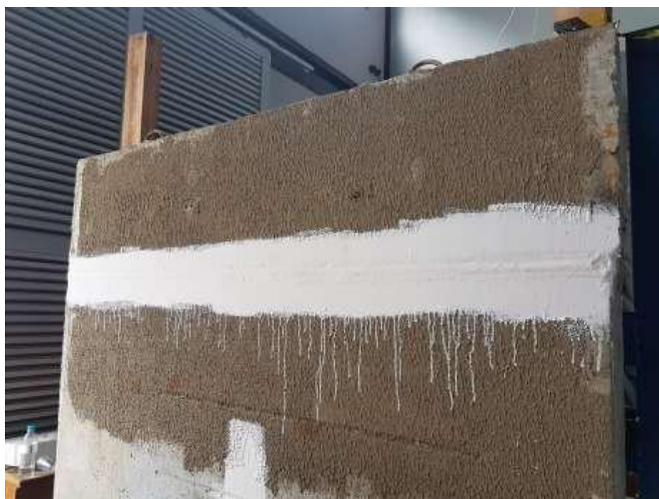
Figura 23: Painel e junta impermeabilizada conforme procedimento preparado para ensaio. Fonte: LAEES – UFMG
