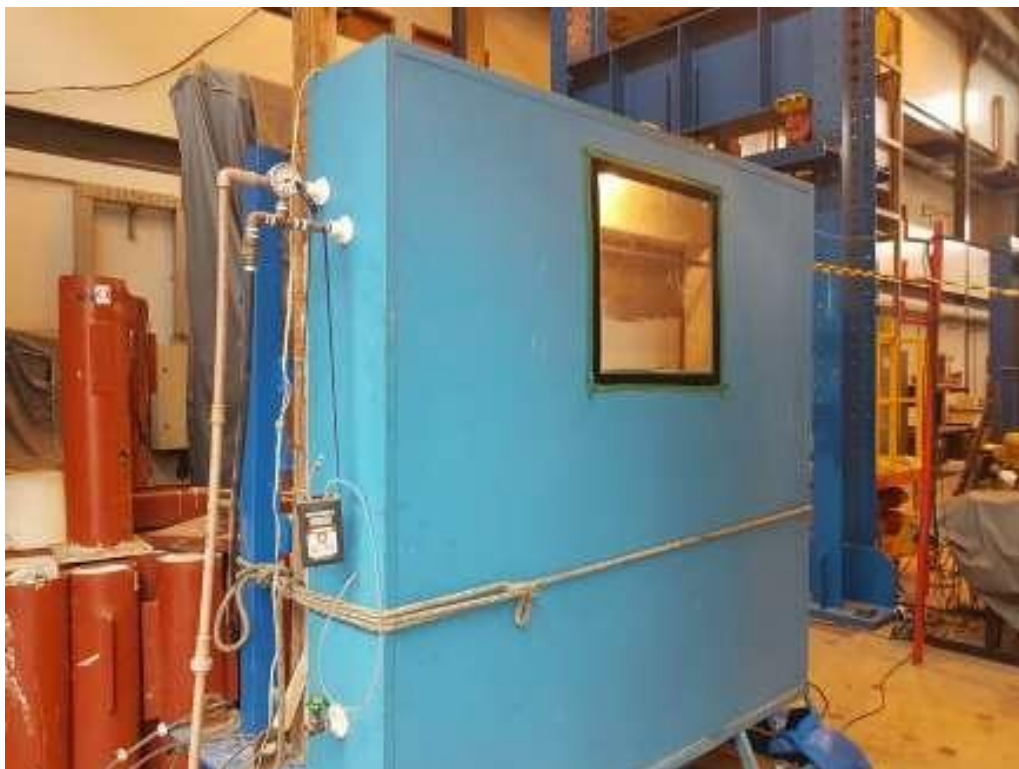
Figura 22: Câmara para ensaio de estanqueidade. Fonte: LAEES – UFMG
