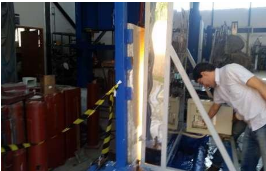
Figura 24: Aquecimento da junta e parede com uso de painel radiante. Fonte: LAEES – UFMG
