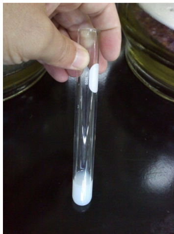
Figura 57: Teste qualitativo para presença de íon cloreto no material filtrado oriundo do processo de polimerização.
