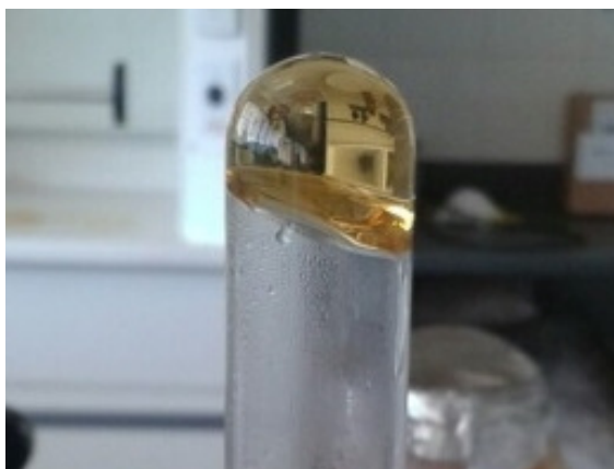
Figura 77: Aspecto gelatinoso formado pelo sistema A50-S0 contendo 3,0% de BPO após aquecimento a 80 °C por 48 horas.
