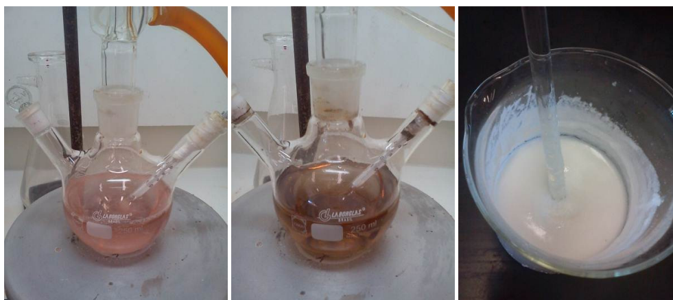
Figura 48: Estágios do processo de sulfonação do CFS para a obtenção do SCFS. À esquerda é apresentado o reator montado no início da síntese, após a adição dos reagentes e início de aquecimento; ao centro é apresentado o aspecto da mistura reacional após o término da reação; à direita é apresentado o aspecto final do sólido pastoso obtido após a adição de NaCl e antes da última etapa de filtração à vácuo.
