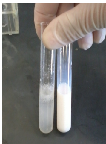
Figura 61: Aspecto dos ensaios de solubilidade/estabilidade das soluções monomérica (Esq.) e polimérica (Dir.) após a adição de tolueno na proporção volumétrica de 1:1.
