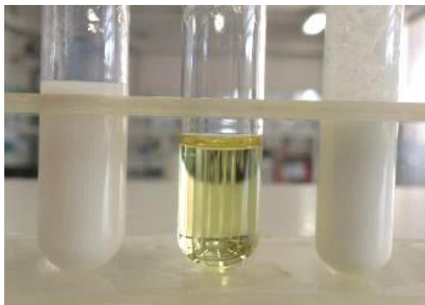
Figura 74: Ensaio de estabilidade da solução polimérica A0-S10 com os solventes DMAc+água, tolueno e água pura, respectivamente, na proporção de 1:1 de solvente em relação a solução polimérica.
