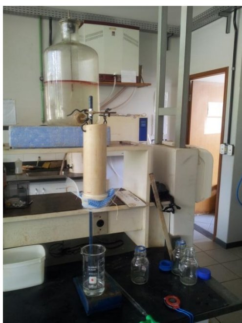
Figura 5.13 – Procedimentos de medição do volume e coleta de amostras no ensaios de coluna para determinação do fator de retardamento de COD do LF e LVA.
