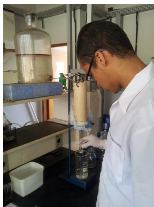
Figura 5.13 – Procedimentos de medição do volume e coleta de amostras no ensaios de coluna para determinação do fator de retardamento de COD do LF e LVA.
