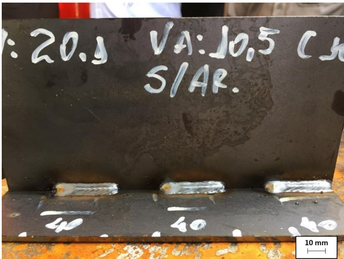
Figura 24 – Quantidade de Respingo ArC10 sem uso de Anti-respingo
