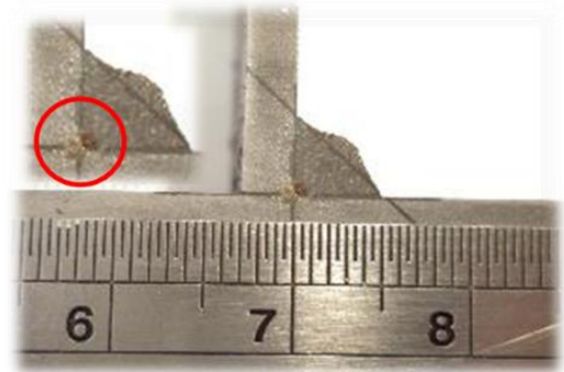
9A Gás de Proteção = ArC10 (C10) - DBCP (Normal) Penetração Horizontal = 0,00 mm Penetração Vertical = 0,00 mm
