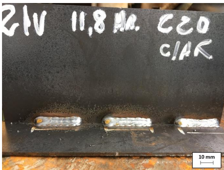
Figura 26– Quantidade de respingo gerados com a mistura ArC10 com uso de anti-respingo
