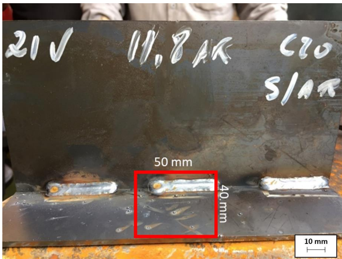
Figura 25 – Quantidade de respingo ArC20 sem uso de Anti-respingo
