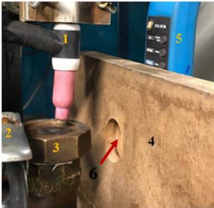
Figura 3.7 - Montagem para aquisição da luminosidade do arco elétrico.
