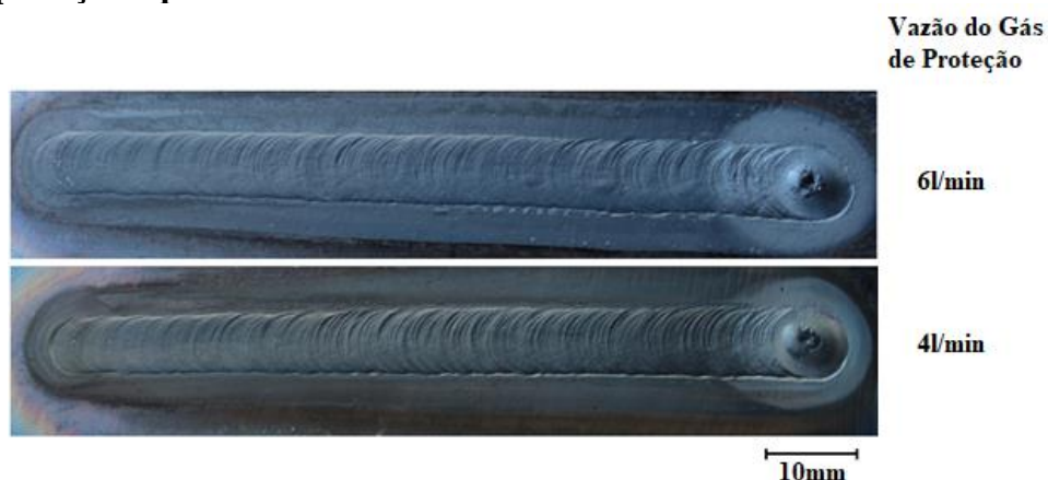
Figura 4.19: Imagens das superfícies de soldas com diferentes vazões do gás de proteção aquecido a 150°C.
