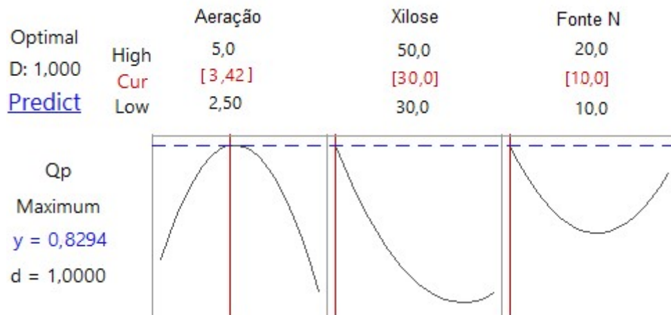
Figura 38: Condições de otimização para produtividade em xilitol ( Q_p ) ajustada pelo modelo, após cultivo de Meyerozyma caribbica UFMG08 em hidrolisado hemicelulósico de torta de macaúba.
