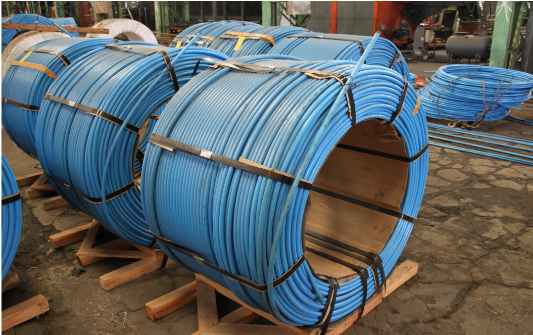
FIGURA 2.1 –Cordoalhas Engraxadas e Plastificadas armazenadas em rolos para posterior corte na medida da laje.
