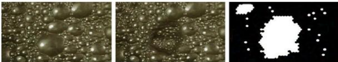
Figura 3.28 - Medição de estabilidade da espuma em dois frames consecutivos. Fonte: Adaptado de Nakhaei et al. (2019).
