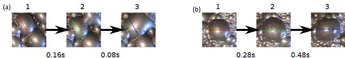
Figura 3.24 - Sequência de imagens mostrando linhas na superfície de uma bolha quando ocorre coalescência (a) com bolha adjacente na superfície; (b) com bolha adjacente abaixo da superfície da espuma.
