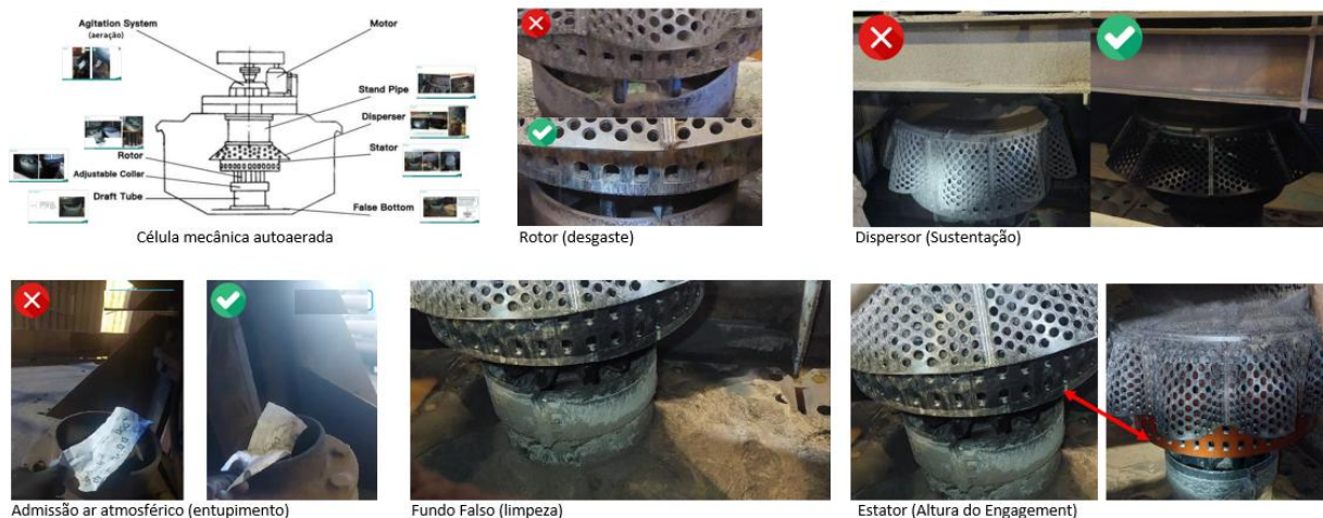
Figura 3.5 - Exemplos de problemas em célula mecânica autoaeradas.
