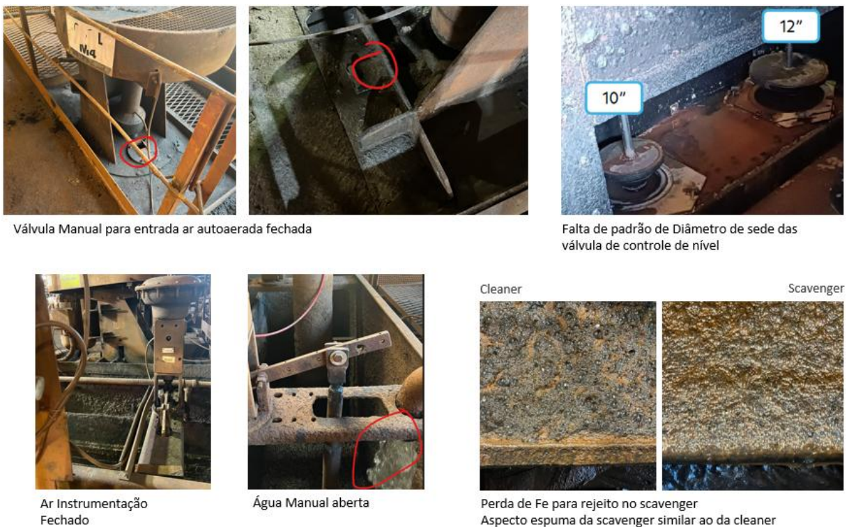
Figura 3.4 - Problemas operacionais que influenciam no desempenho da flotação.
