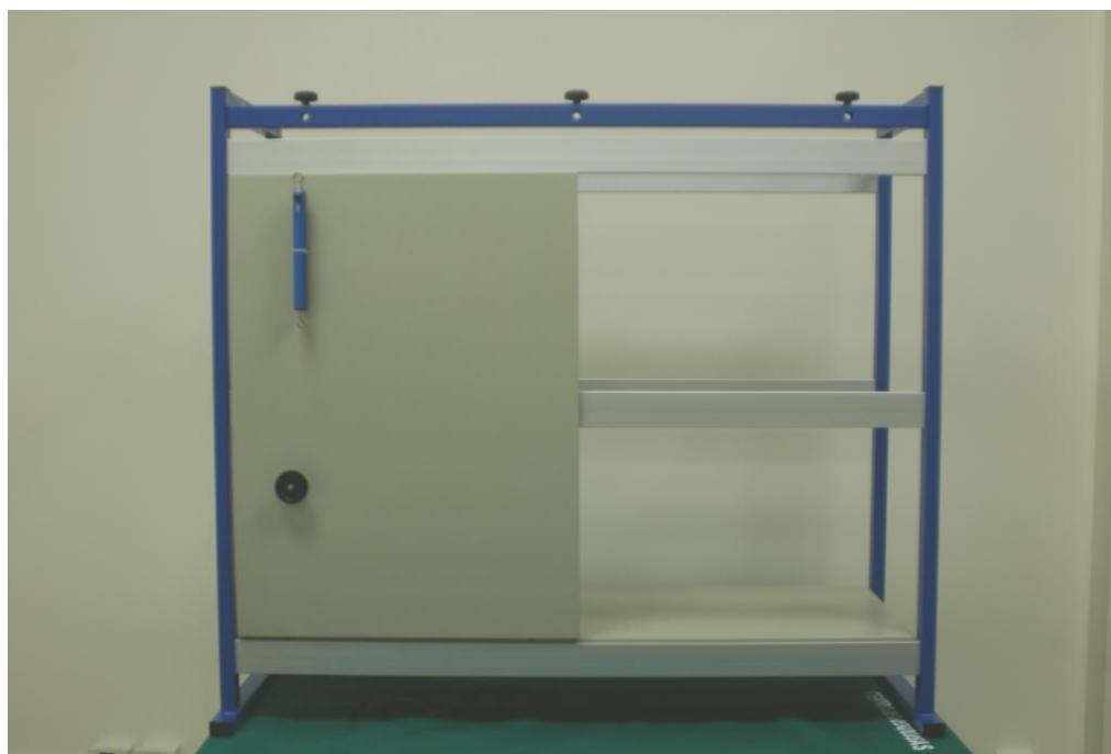
FIGURA 5 - O dinamômetro e a polia estão fixados em uma placa magnética, TBF-106, MINIPA® e montados em uma estrutura de demonstração multiuso, TBF-100, MINIPA®, com prateleira TBF-101, MINIPA®
