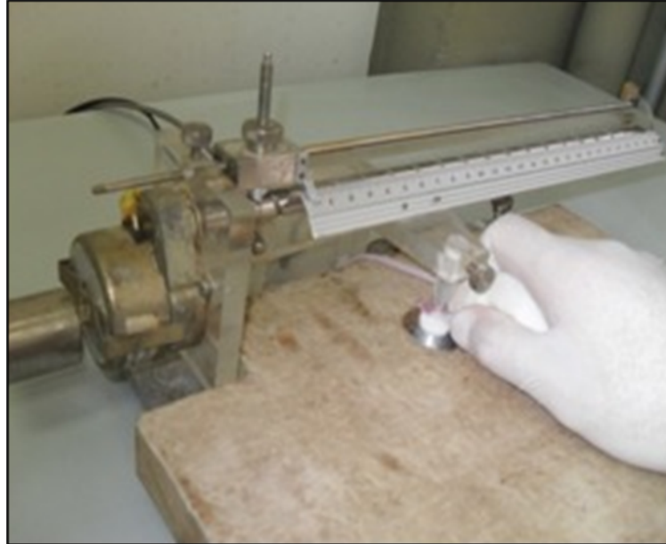
Figura 14. (Ugo Basile, Itália) Utilizado para medir o limiar de resposta ao estímulo mecânico
