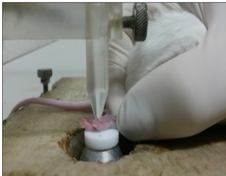
Figura 15. Parte compressora do aparelho (Ugo Basile, Itália) utilizado para medir o limiar de resposta ao estímulo mecânico aplicado na pata de camundongos.
