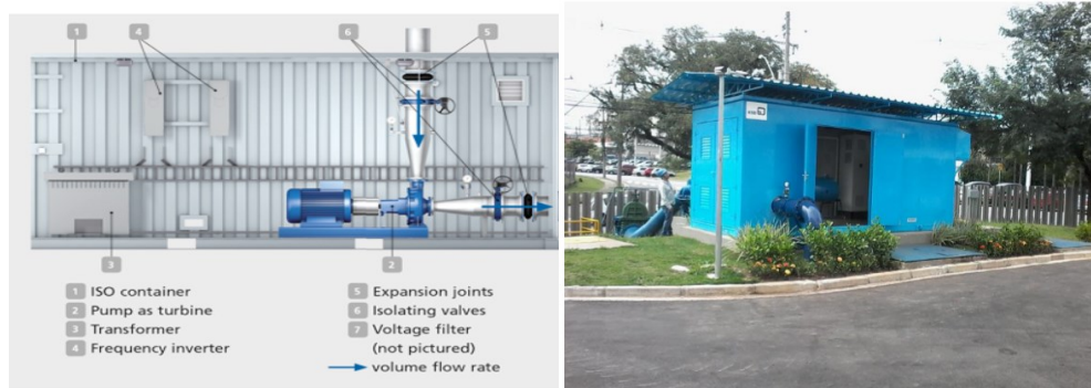
Figura 3.21– BFT KSB's Powerhouse –Projeto Sabesp Tamboré. Fonte: [53][54].
