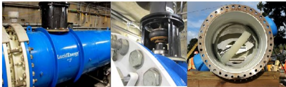
Figura 3.17– Turbina LucidEnergy em Portland.
