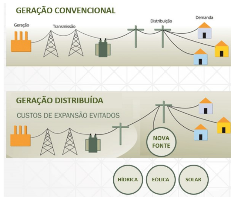
Figura 1.3– Comparação entre geração convencional e distribuída.
