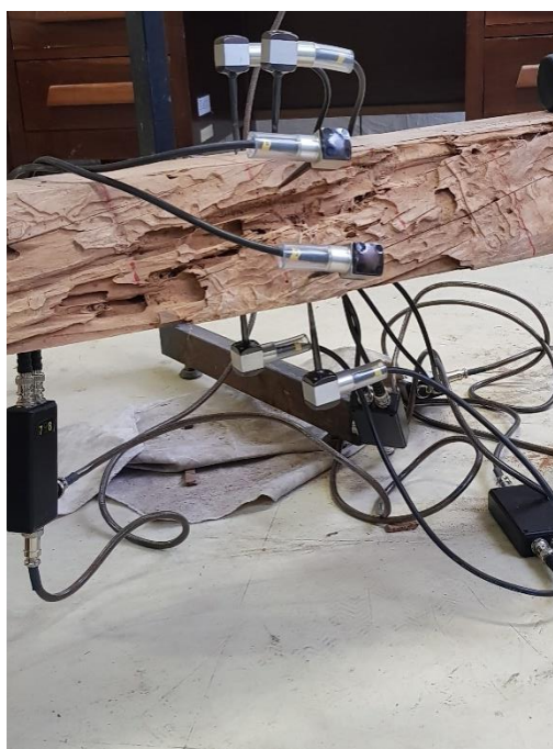
Figura 51: Fixação dos transdutores na seção transversal do cabo 1.
