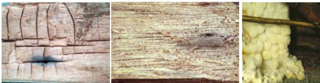
Figura 28: (a) Podridão castanha; (b) Podridão branca ou fibrosa; (c) Podridão branca; Fonte: Pereira, 2009.
