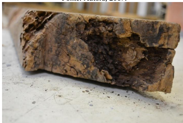
Figura 57: Podridão castanha e fibrosa na madeira na ligação inferior do caibro 2. Autora: 2017.
