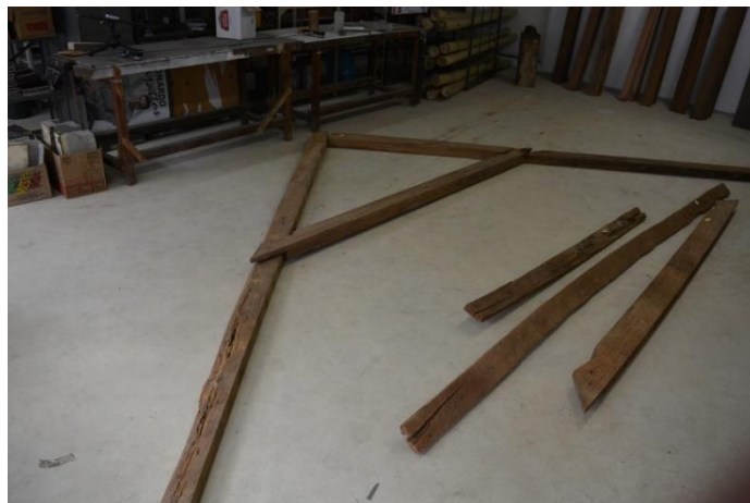
Figura 41: Tesoura de caibro-armado alocada no LPT-UFMG. Fonte: Autora, 2017.
