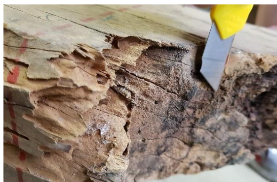
Figura 44: Raspagem da superfície transversal para identificação macroscópica da peça. Fonte: Autora, 2017.
