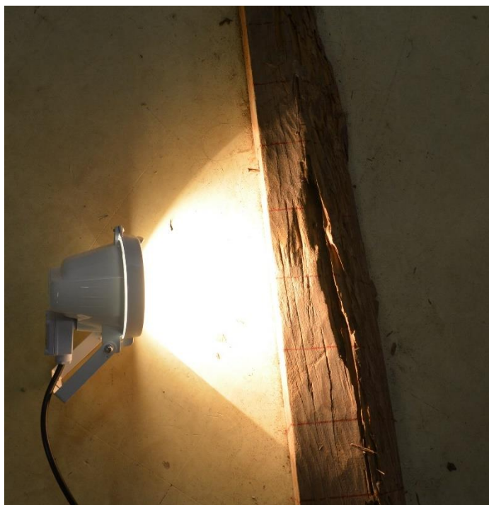
Figura 48: Excitação térmica do método ativo realizado com o refletor de lâmpada alógena. Fonte: Autora, 2017.
