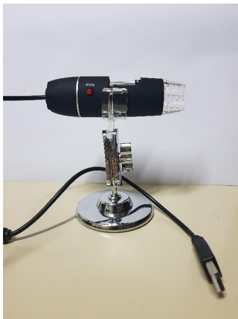
Figura 43: Lupa eletrônica com aumento mínimo de 50 vezes. Fonte: Autora, 2018.
