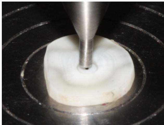
Figura 19: Espécime posicionado para teste de push-out .
