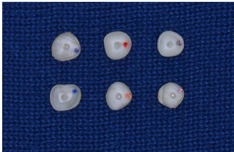
Figura 16: Espécimes obtidos após o seccionamento e identificados conforme a localização, sendo: azul – cervical, vermelho – médio, preto – apical.
