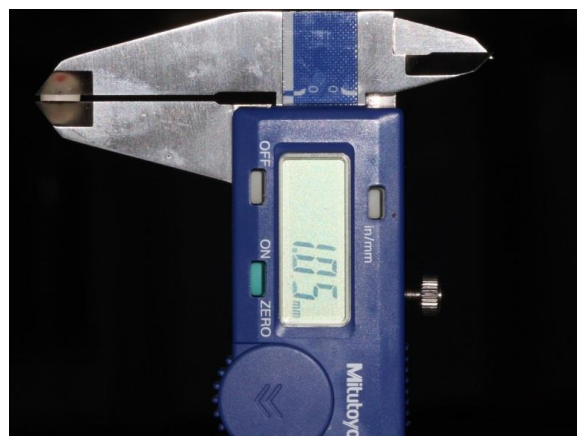
Figura 17: Aferição da espessura dos espécimes com paquímetro digital.
