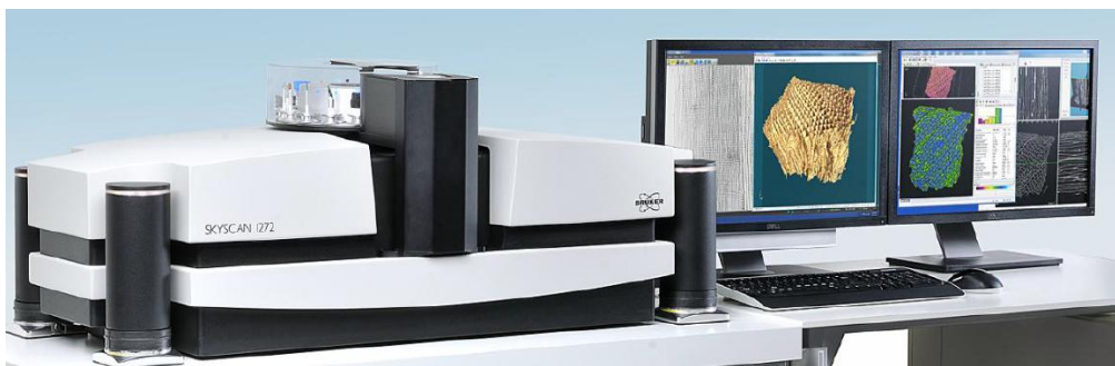
Figura 12: Micro CT (SkyScan 1272 – Bruker) utilizado para análise do volume de cimento e das porosidades no interior do cimento e da interface dentina/cimento.
