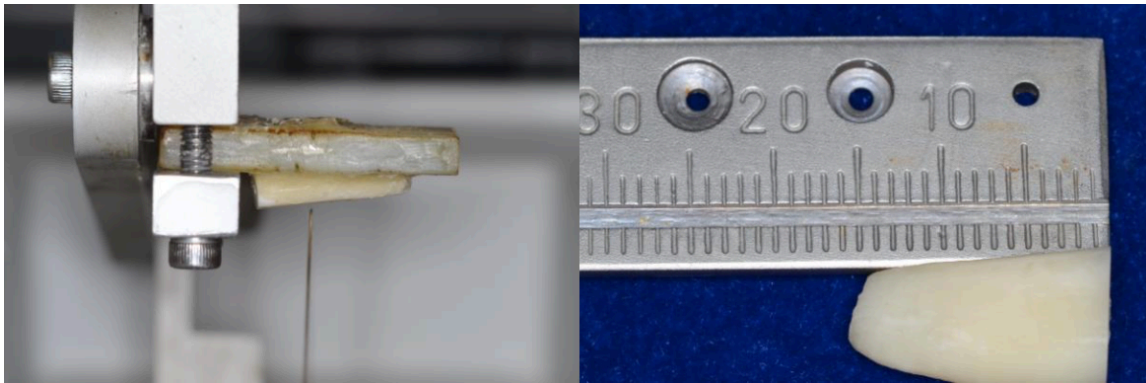
Figura 4: Padronização do comprimento do espécime em 15 mm.
