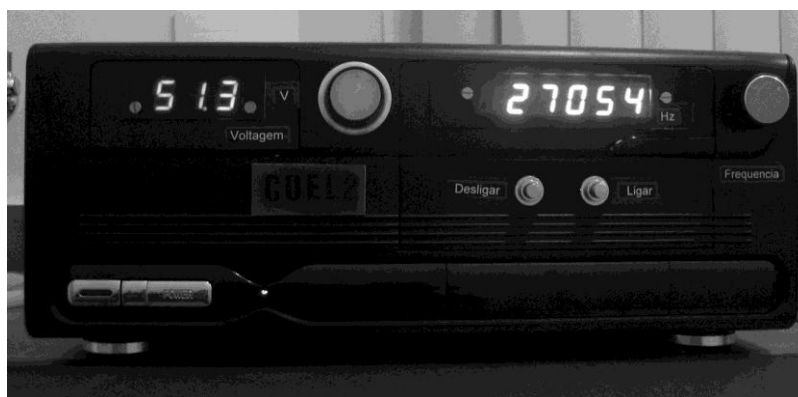
FIGURA 5.7 - Fotografia da fonte de alta tensão do equipamento de coalescência eletrostática
