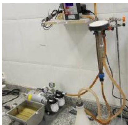
Figura 4.2– Kit para a realização do teste de folha ( leaf test ).
