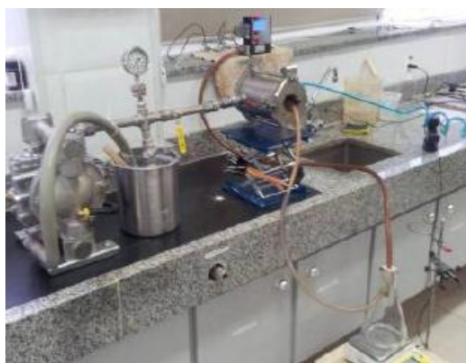
Figura 4.3– Kit para a realização do teste de filtração a pressão.
