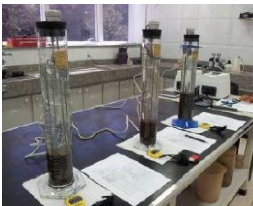
Figura 4.1– Kit para a avaliação da sedimentação estática.
