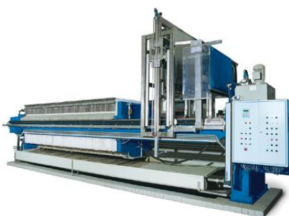
Figura 3.18 - Filtro prensa tipo side bar (ANDRITZ, 2014)
