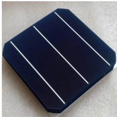
a) Célula solar de silício monocristalino [AYB 23]
