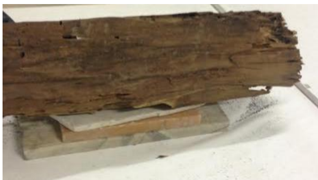
FIGURA 30 - Amostra deteriorada utilizada para ensaio em laboratório.
