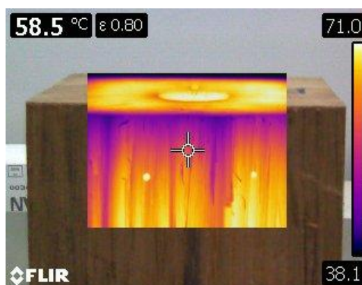
FIGURA 29 - Termograma obtido de amostra com furos.
