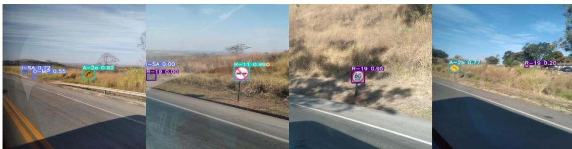
Figura 6 - Detecção de placas (BR 262) da rede YOLO v8 para 10 épocas.
