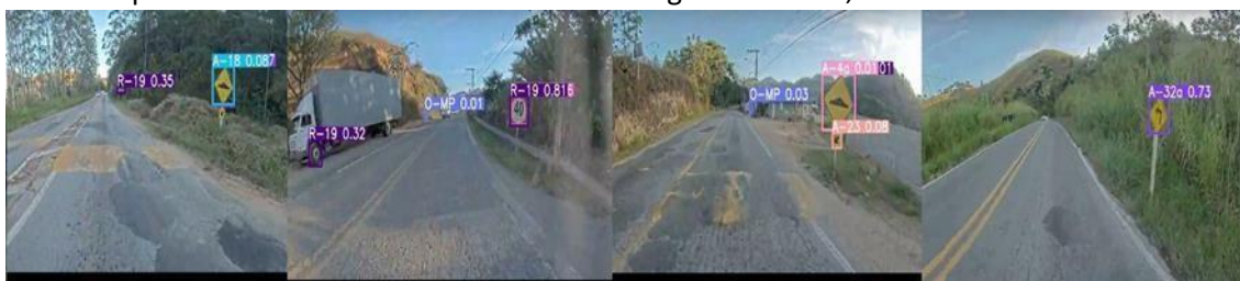
Figura 7- Detecção de placas da rede YOLO v8 para 10 épocas.
