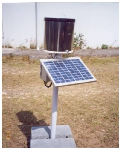
Figura 18: Pluviógrafo instalado no Jardim Montanhês, dentro da área da COPASA (Convênio UFMG/URBEL/PBH)
