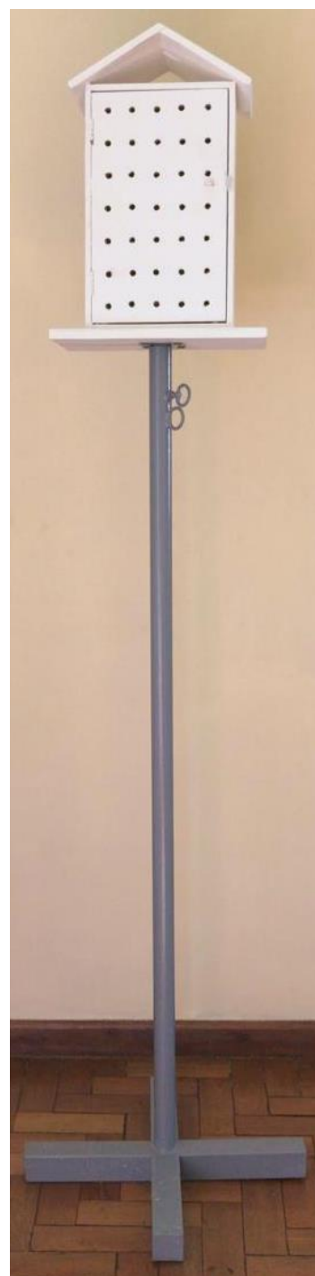
Figura 16 - Especificação dos abrigos meteorológicos de acordo com ASSIS (2010). Especificações técnicas do Abrigo Meteorológico de campo (à esquerda); Abrigos meteorológicos confeccionados pela autora (à direita)
