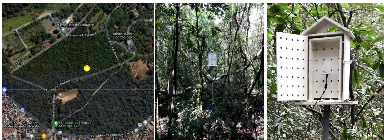
Figura 18 - Localização Abrigo 1 (da esquerda para a direita): (01) Localização do abrigo meteorológico na mata da Fundação de Parques Municipais e Zoobotânica de Belo Horizonte; (02) vista frontal do abrigo meteorológico; (03) Abrigo Meteorológico aberto para manutenção
