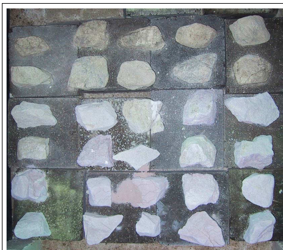
Figura 5-42 – Situação das amostras da primeira batelada depois da queima.
