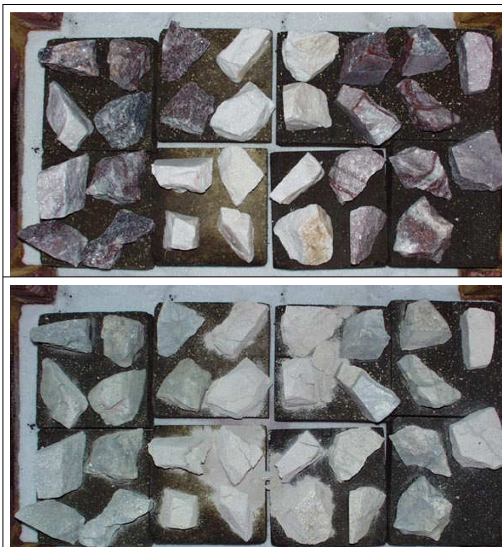
Figura 5-44 – Situação das amostras da segunda batelada antes (acima) e depois da queima (abaixo).
