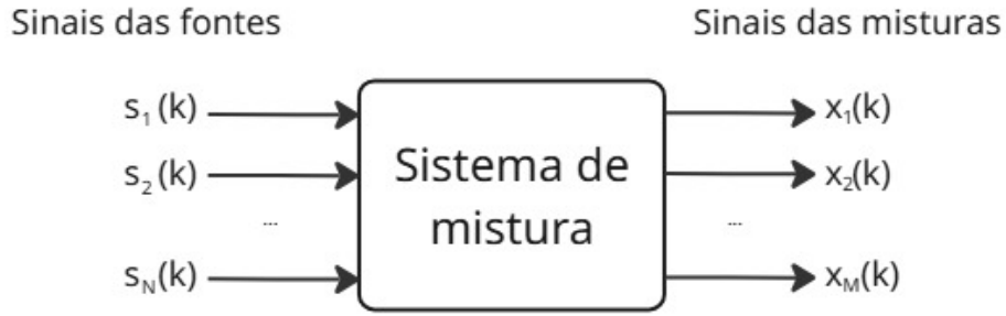
Figura 2 – Processo de formação das misturas. O sistema efetua operações nos N sinais de entrada (fontes) resultando em M sinais de saída (misturas). Fonte: Autoria própria.
