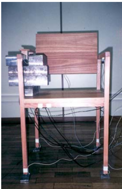
Figura 8.3 Calibração da trava assento lateral direita
