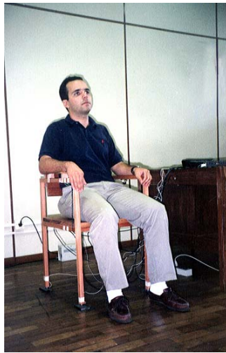
Figura 9.3 Valores de carga nos pés devido ao assentar bruscamente no meio do assento: ensaio 1
