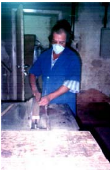
Figura 6.6 Fase inicial de fabricação da cadeira-modelo: corte das peças
