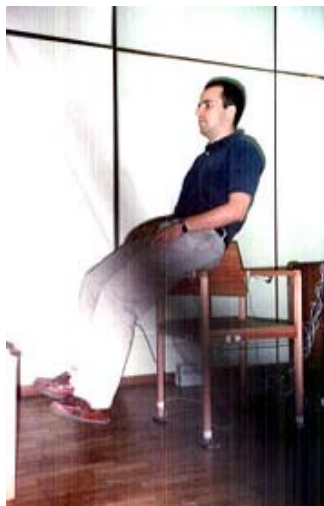
Figura 9.11 Valores de carga nos pés da cadeira quando a pessoa assenta no apóia-braço direito com os pés levantados: ensaio 1
