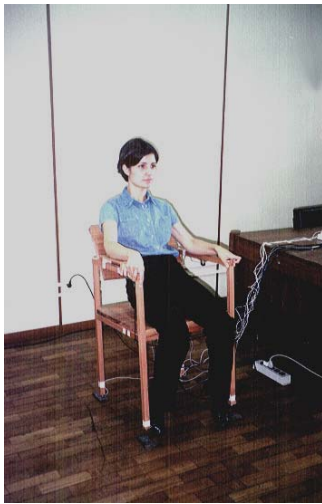
Figura 9.15 Valores de carga na trava do encosto ao se reclinar a cadeira: ensaio 2
