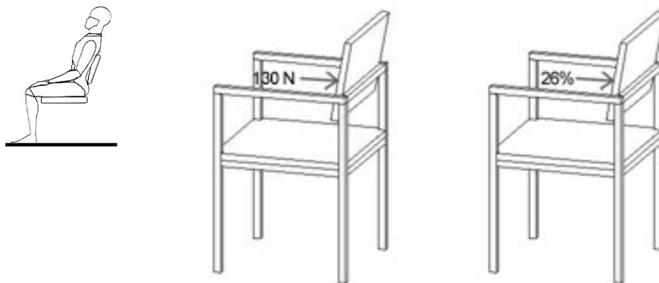
Figura 8.15 Valores de carga na trava do encosto quando adotada a postura relaxada.
