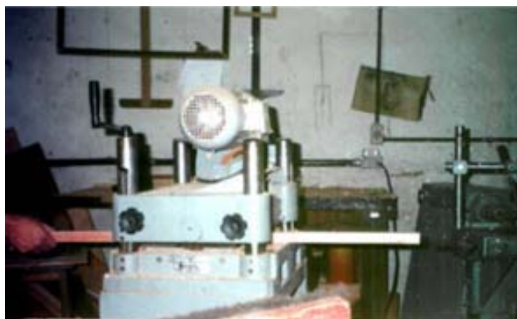
Figura 6.7 Fase de uniformização da seção das peças da cadeira-modelo
