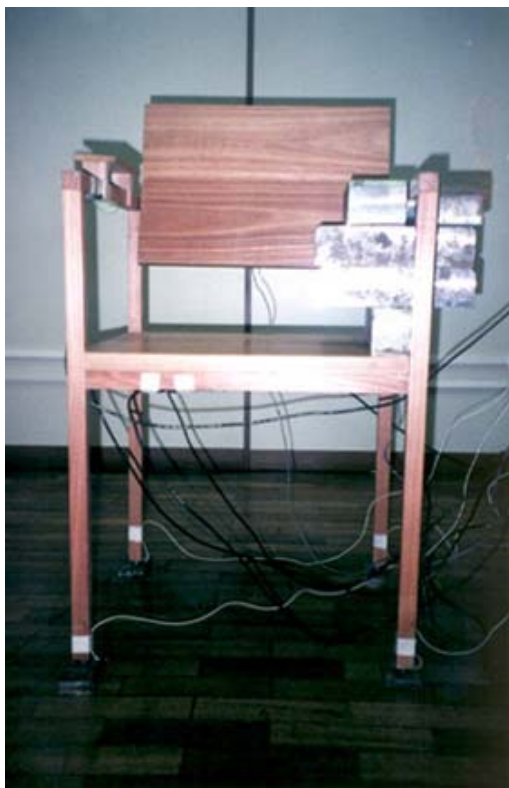
Figura 8.4 Calibração da trava assento lateral esquerda
