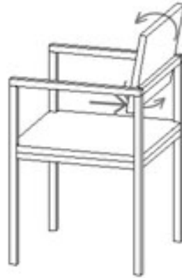
Figura 8.12 Torção que ocorre na trava do encosto quando adotada a postura ereta.
