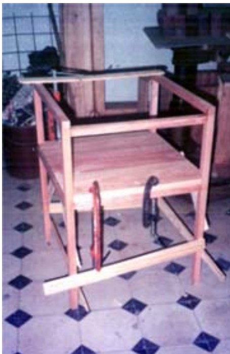
Figura 6.9 Fase após a montagem dos encaixes
