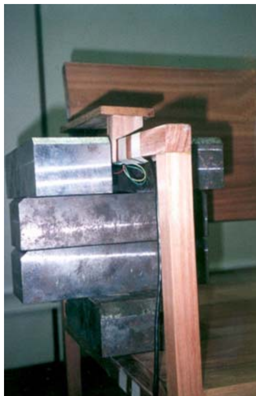
Figura 8.3 Calibração da trava assento lateral direita
