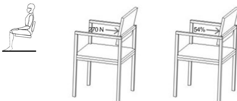
Figura 8.21 Valores de carga na trava do encosto ao se reclinar a cadeira.
