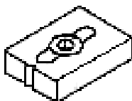
Figura 7.11 Encaixe adequado para ligações de peças de madeira
