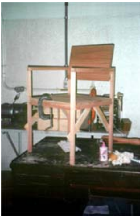
Figura 6.10 Fase de secagem dos encaixes
