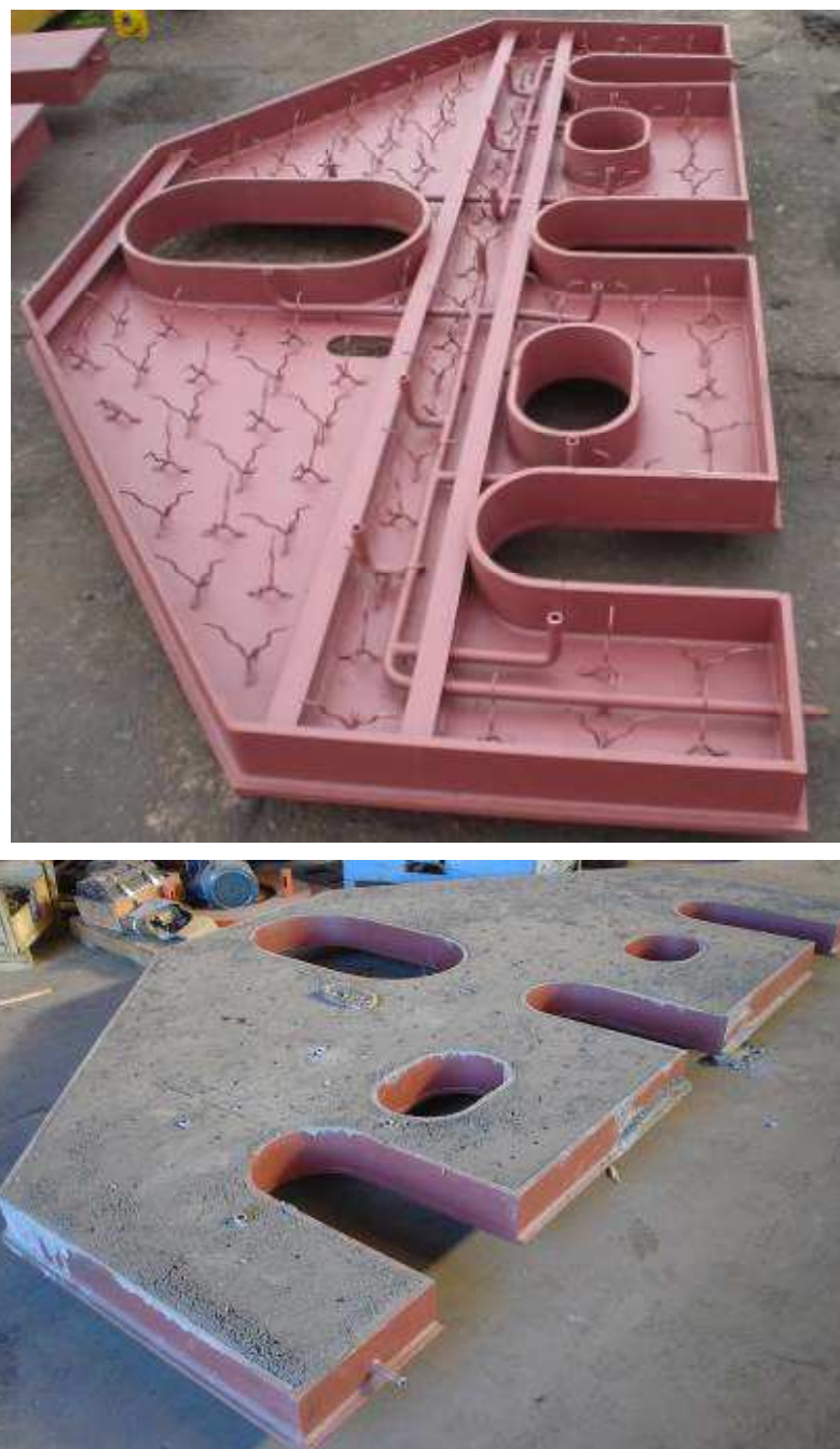
Figura 3.32: Fotografias da tampa do distribuidor utilizada para inertização na Gerdau Aços Especiais Piratini. Superior: posição das tubulações de argônio; inferior: resultado após colocação de concreto. Fonte: FERNANDES, CELIBERTO e BOSCHETTI (2007).
