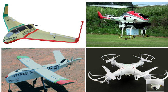
Figura 2.1: VANTs de asa fixa (esquerda) e de asa rotativa (direita). Fonte: www.xmrobots.com.br
