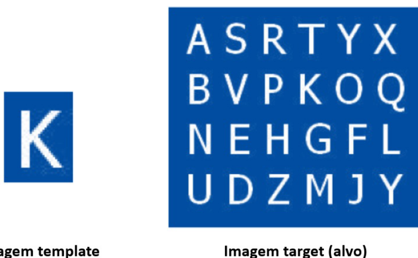
Figura 2.2: Exemplo de aplicação do template matching em reconhecimento de caracteres.
