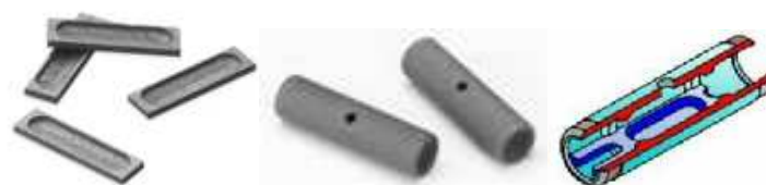
Figura 2.2 – Plataformas de L'Vov, tubos de grafite e corte de um tubo com plataforma de L'Vov
