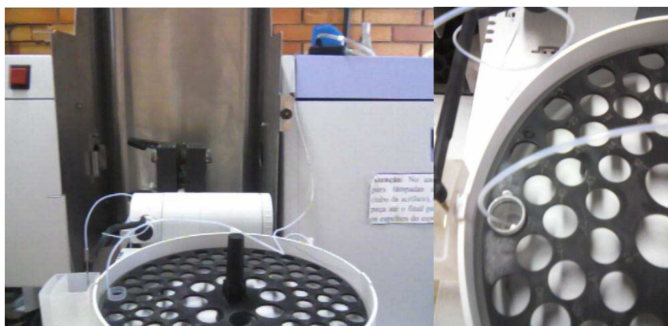
Figura 2.1 – Uso de aerador de aquário para manter suspensão homogênea.
