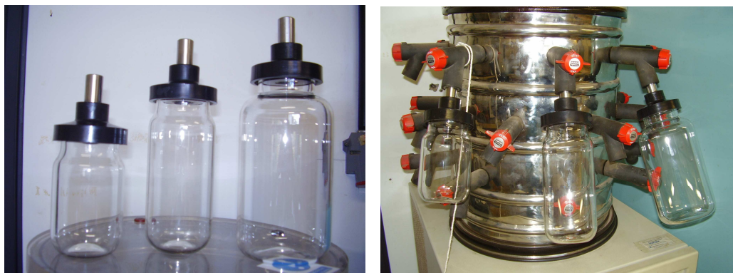
Figura 2.3 – Frascos de liofilização (à direita), frascos acoplados ao liofilizador (à esquerda).
