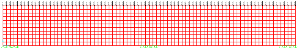
Figura 28 – Modelo 2 – Malha, condições de contorno e carregamento – L/h = 3,64 .
