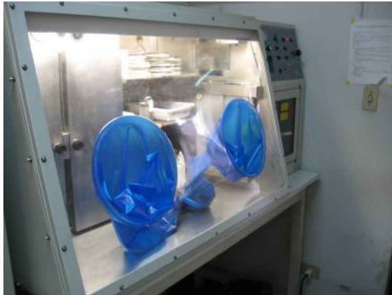
Figura 4.20 - Câmara de anaerobiose onde as placas de Petri ficam incubadas por 48 horas a 35°C e após este período é então feita a contagem visual dos pontos com UFCs.
