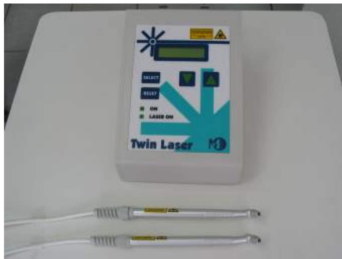
FIGURA 4.3 – Laser em baixa intensidade Twinlaser - mmoptics (Laser n.2)
