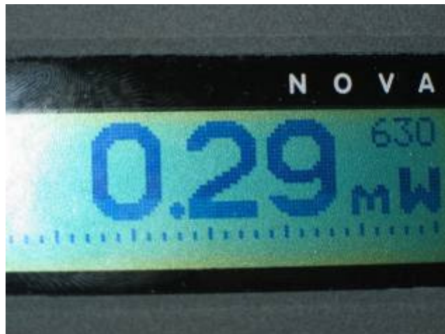
Figura 4.13 – Imagem do display digital do Power Meter medindo a potência transmitida pela cuba com o corante.
