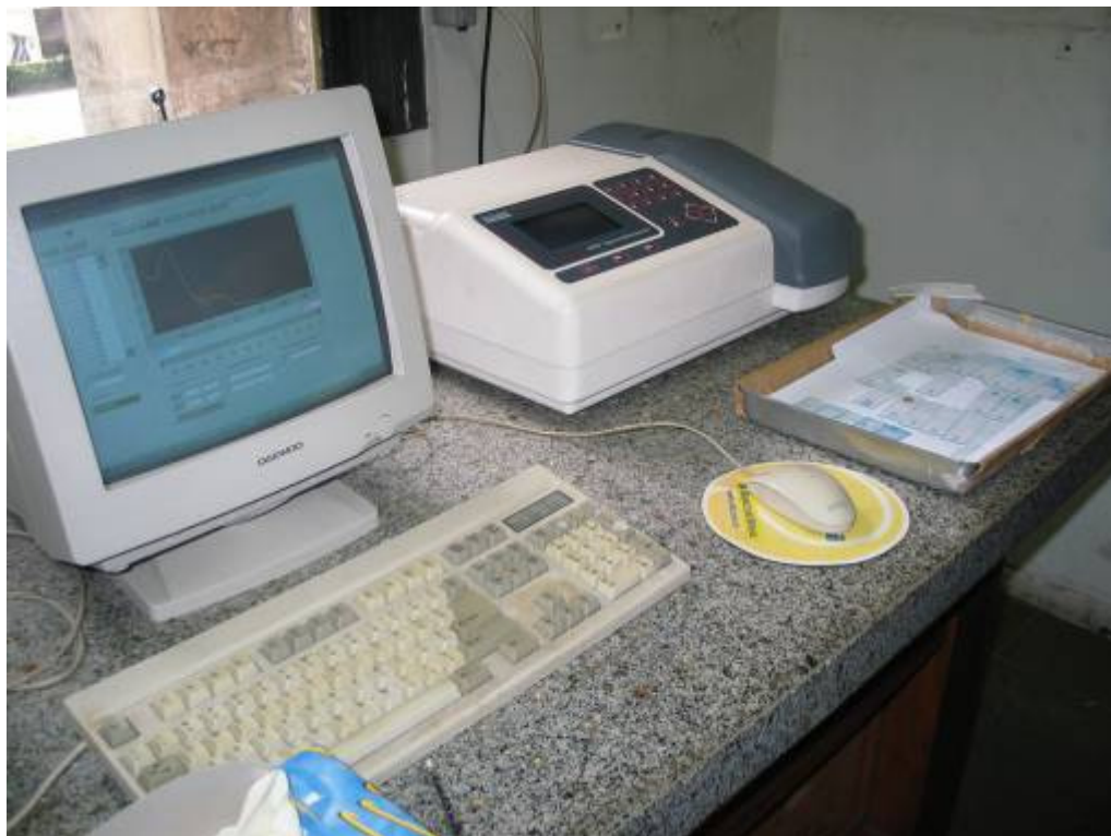
FIGURA 4.5 – Espectrofotômetro - JEN WAY Spectrophotometer 640, EUA
