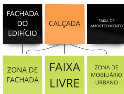
Figura 48 - Decomposição do sistema “calçada”
