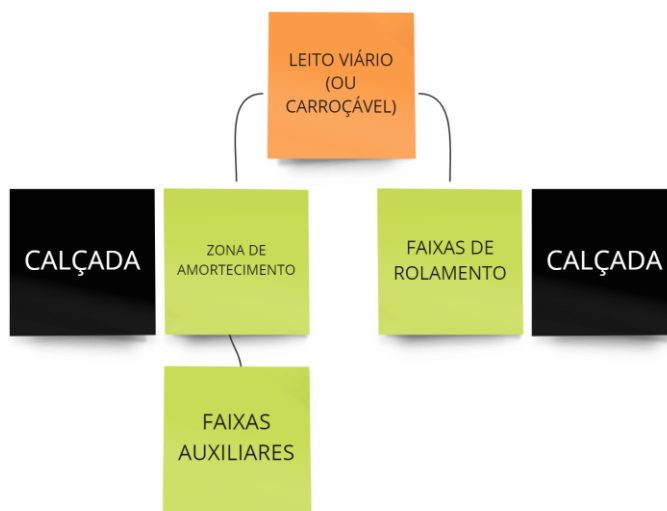
Figura 49 - Decomposição do sistema “leito viário”
