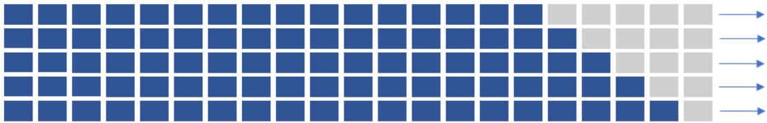
Figura 4.12 – Validação cruzada de séries temporais, onde cada conjunto de treino (azul) contém uma observação a mais que o conjunto anterior, e conseqüentemente cada conjunto de teste (cinza) tem menos uma observação que o anterior (Adaptado de HYNDMAN, 2014).
