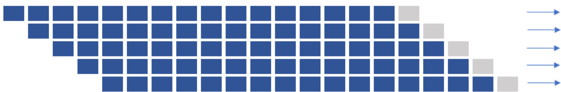
Figura 4.14 – Validação cruzada usando a janela rolante (Adaptado de BERGMEIR, 2013)
