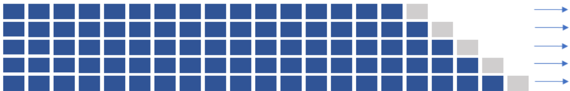
Figura 4.13 - Validação cruzada de séries temporais com base em previsões de um passo. Os pontos azuis representam os conjuntos de treino, o cinza de teste e os pontos em branco são ignorados (Adaptado de HYNDMAN, 2014).
