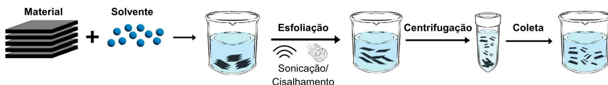
Figura 7 – Esquema do processo de esfoliação em fase líquida por sonicação e cisalhamento. Adaptado de [43].
