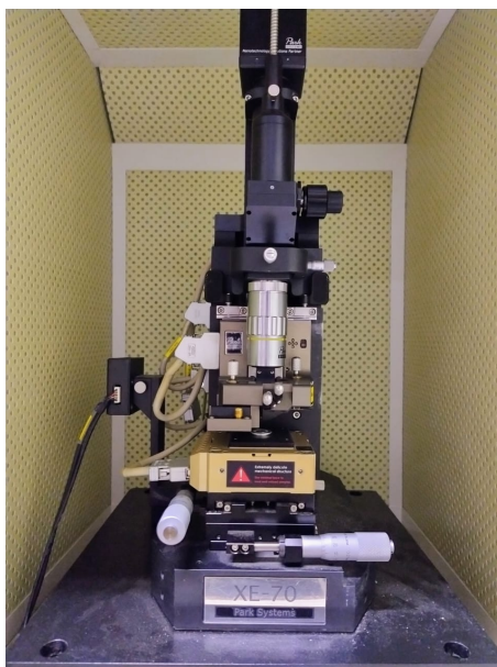
Figura 23 – Microscópio Park XE-70 utilizado para medidas de AFM. Imagem de autoria própria.
