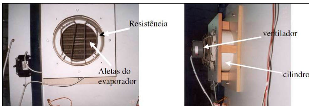
FIGURA 6. Montagem da resistência elétrica na bancada. Fonte: Fabris (2006).
