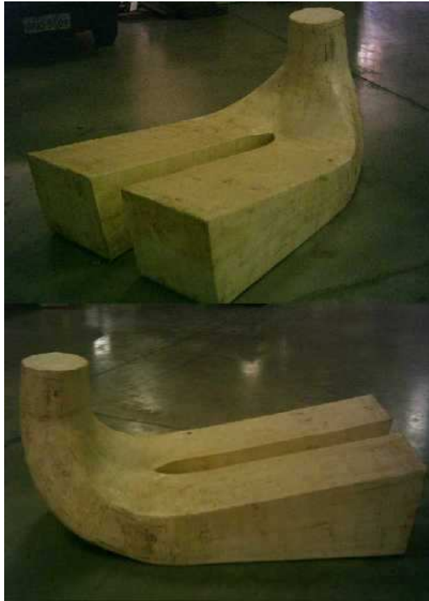
Figura 4.23, Molde pronto para revestimento com fibra de vidro, Fonte própria.
