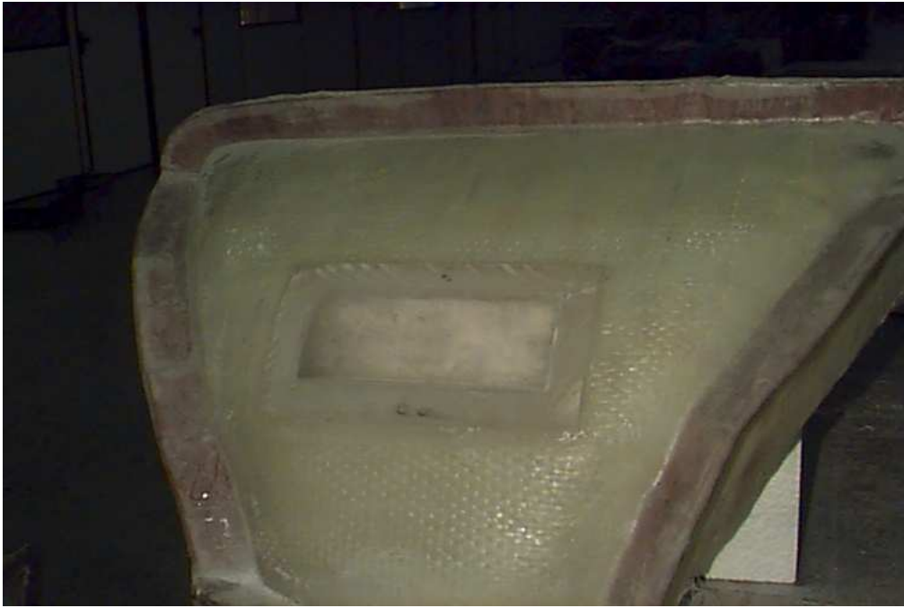
Figura 4.27, Vista de uma das janelas de acrílico instaladas no modelo do tubo de sucção, Fonte própria.
