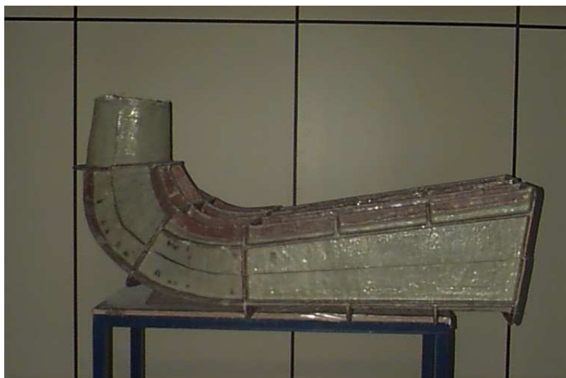
Figura 4.24, Vista lateral do modelo do tubo de sucção, Fonte própria.
