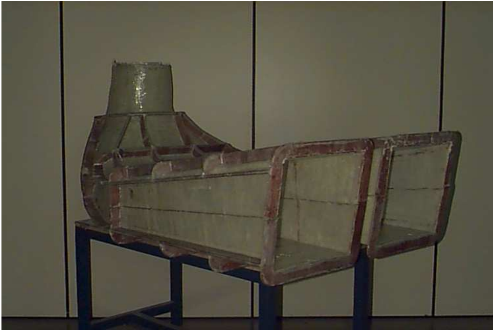
Figura 4.25, Vista do modelo do tubo de sucção, Fonte própria.
