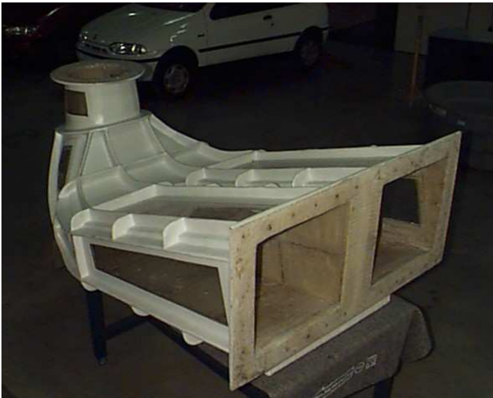
4.28, Tubo de sucção terminado, Fonte própria.
