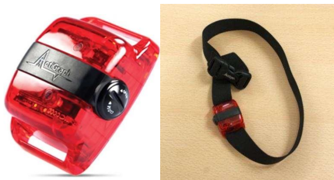
Figura 3- Imagem do acelerômetro e local de utilização.
