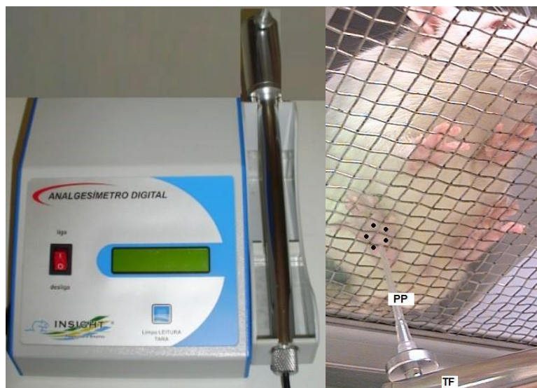
Figura 7 – Aparato utilizado para a avaliação da alodínia mecânica. PP - ponteira de polietileno; TF - transdutor de força. O sítio de estimulação é o centro delimitado pelos pontos pretos.
