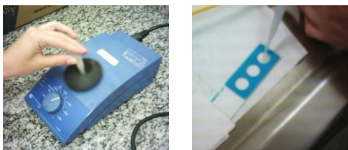
Figura 4.11 – Homogeneização da amostra concentrada em vórtex e preparação da lâmina com 100 \mu\text{L} da amostra.
