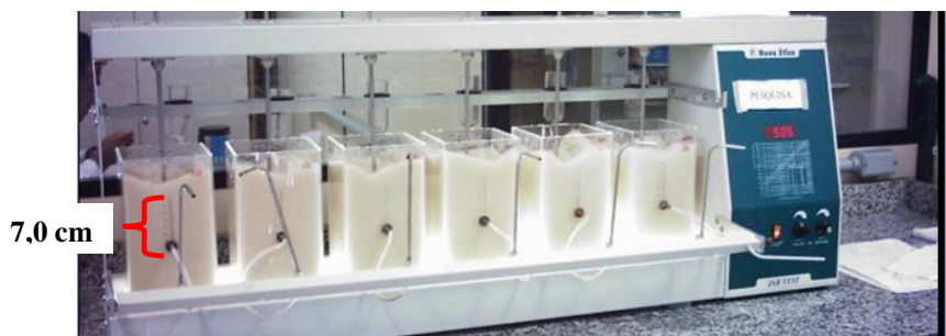
Figura 4.3 – Aparelho de Jarreste utilizado na realização dos experimentos.
