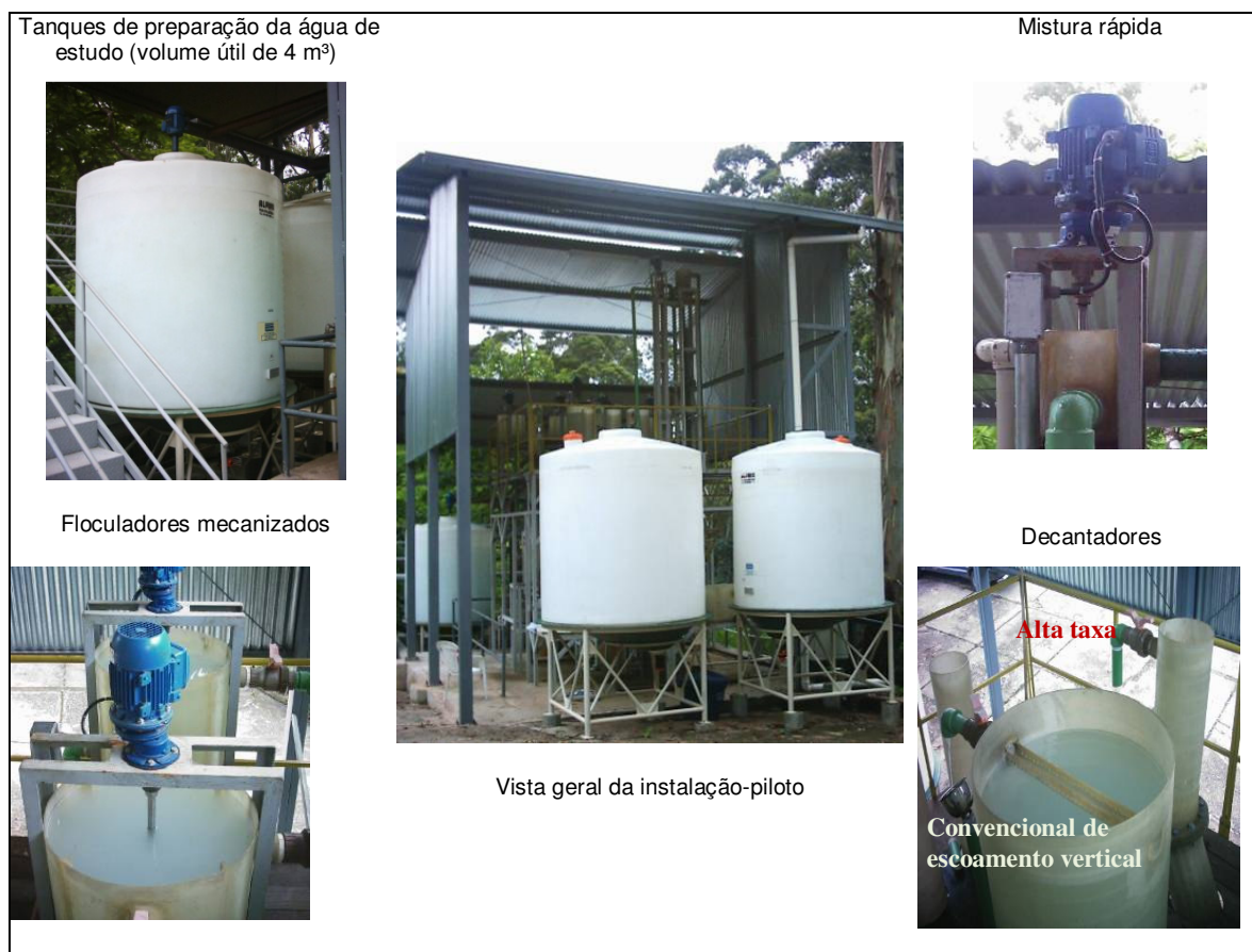
Figura 4.4 – Fotografias da instalação-piloto utilizada na realização dos experimentos.
