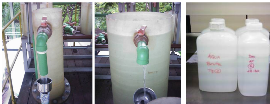
Figura 4.9 – Pontos de coletas dos decantadores de alta taxa e convencional e frascos utilizados nas coletadas das amostras.
