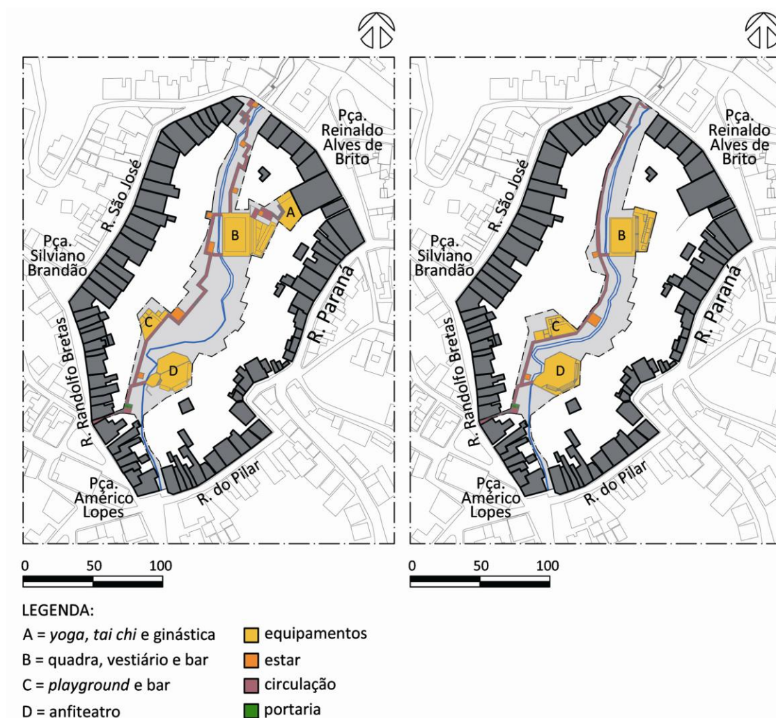
Figuras 28a e 28b Alterações entre o projetado e o executado, no Parque do Vale dos Contos
