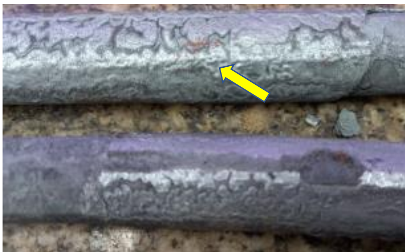
Figura 12: Peças após resfriamento contendo carepa. Fonte: Próprio autor.
