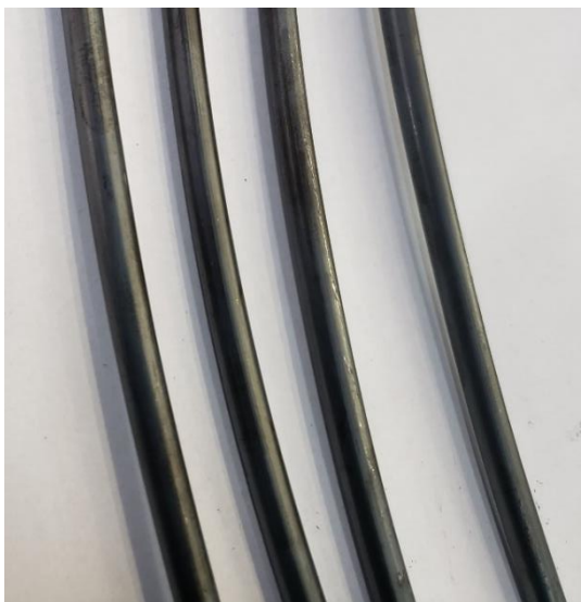
Figura 20: Amostra do fio máquina com baixo teor de Cu (0,07%) e Sn (0,0046%) enornado a alta temperatura e laminado a quente. Superfície lisa, sem defeitos.
