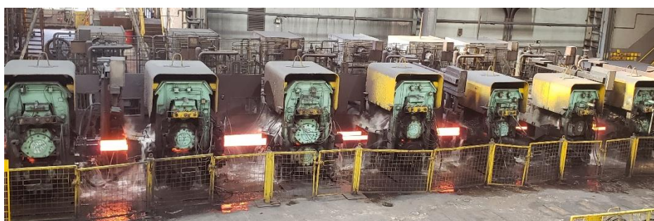
Figura 5: Laminador desbastador ArcelorMittal Aços Longos. Fonte: Próprio autor.
