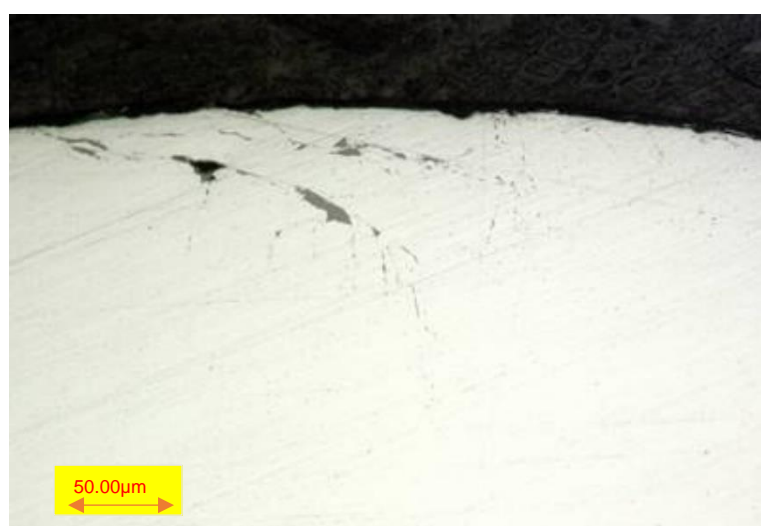
Figura 23: Imagem metalográfica da seção transversal da amostra de fio máquina com maior teor de Cu e Sn, na região de um defeito aumento 200X. Fonte: Próprio autor.
