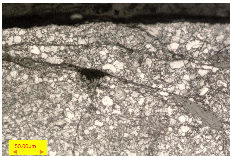
Figura 25: Ampliação de 500x do corte da seção da amostra de fio máquina com maior teor de Cu e Sn atacada com ácido Nital. Presença de defeitos e óxidos.
