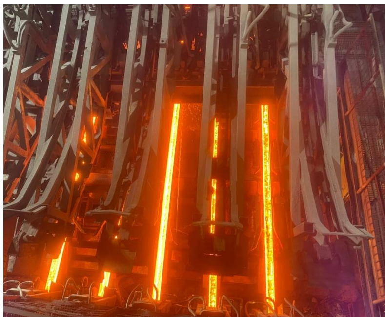
Figura 3: Lingotamento contínuo da aciaria ArcelorMittal Aços Longos Juiz de Fora. Fonte: Próprio autor.
