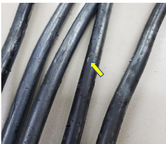
Figura 21: Amostra do fio máquina com maiores teores de Cu (0,23%) e Sn (0,0046%) enornado a alta temperatura e laminado a quente. Superfície rugosa, com defeito de palha. Fonte: Próprio autor.
