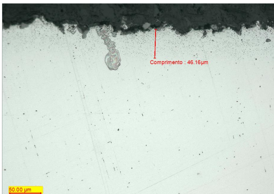
Figura 16: Condição 03, amostra 01 – Tempo de permanência no forno de 4h a 1100°C. Formação de camada de óxidos de 46 µm. Fonte: Próprio autor.
