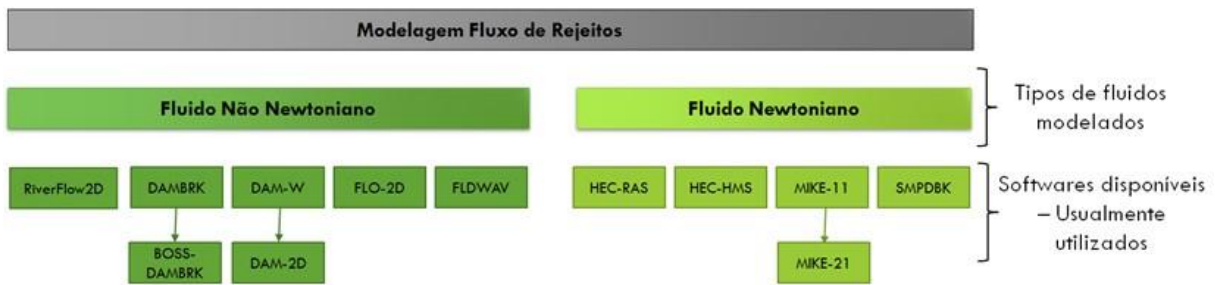
Figura 3.11 – Modelos de propagação de ondas de cheia e Dam Break para fluidos Newtonianos e não-Newtonianos.
