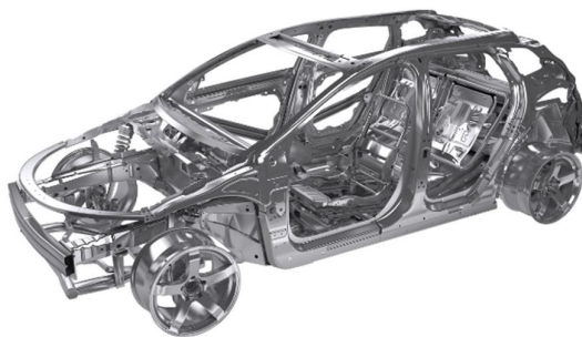
Figura 18 - Estrutura típica de uma carroceria de automóvel [11].
