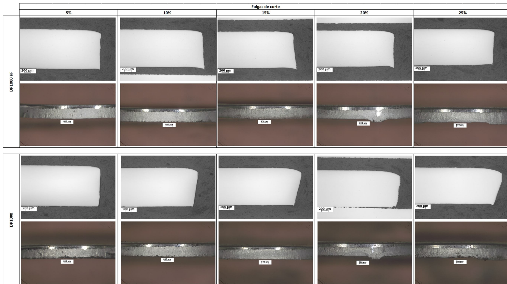
Figura 52 - Seções e aspecto de corte das amostras analisadas em diferentes folgas. Aços DP1000 HF e DP1000.
