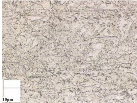
Figura 16 - Microestrutura de aço CP laminado a quente [1].
