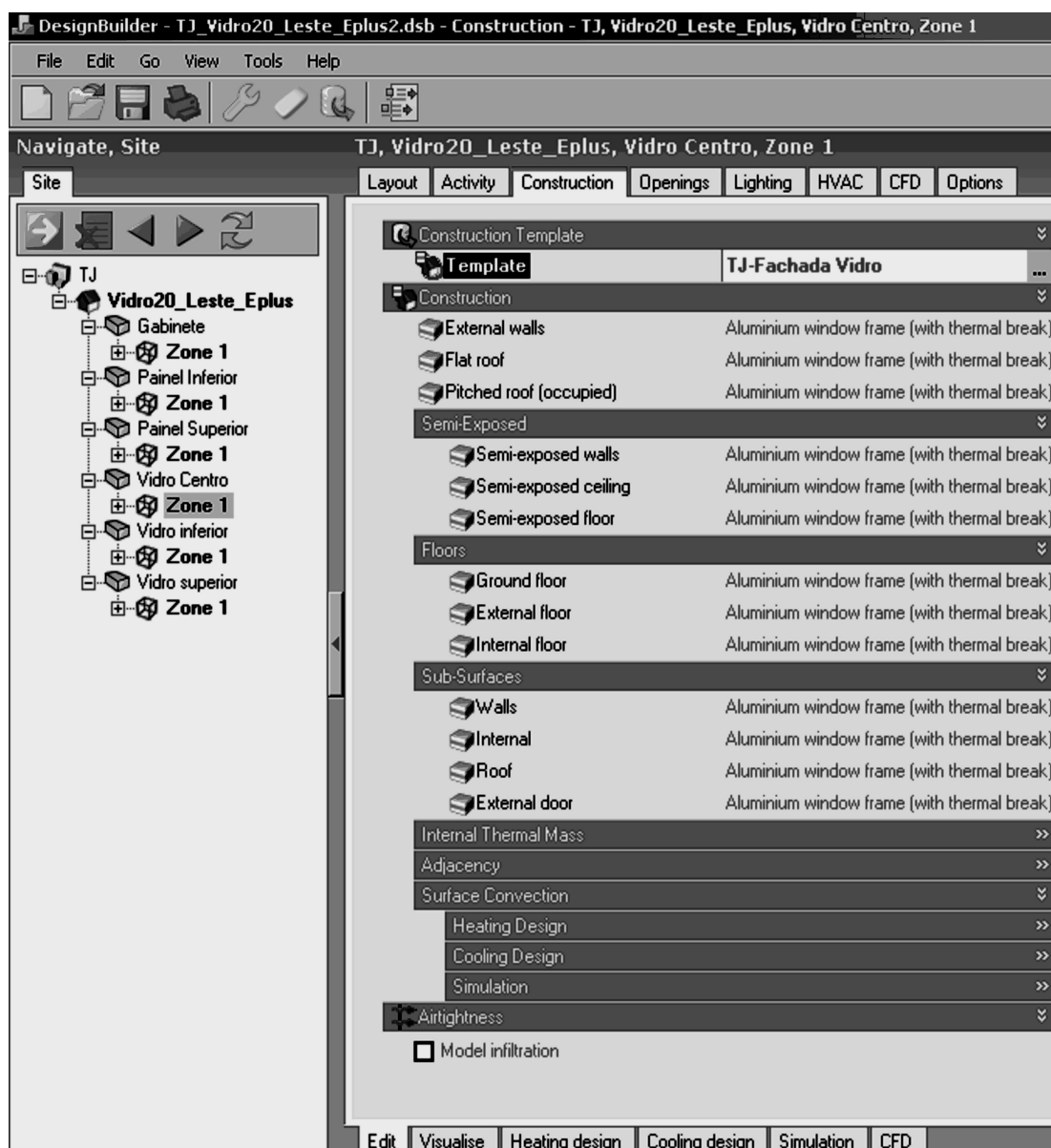
FIG. 19: Imagem da tela “Construction” da zona Vidro Centro, Protótipo “Zonas térmicas”. Mostra que todos os elementos opacos estão configurados como “Aluminium window frame”.
