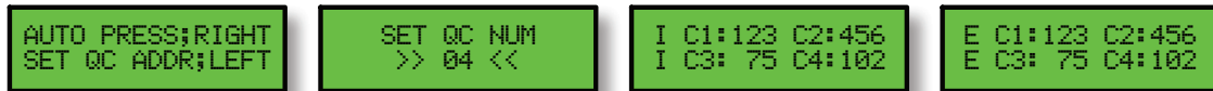
Figura 3.27. Ilustração do comportamento do sistema quando em teste do conversor analógico digital. Nas duas imagens a direita, I representa os valores coletados de cada um dos píxeis da quadricélula do arranjo interno e E para o arranjo externo. C1-4 correspondem aos fotodiodos A,B,C e D respectivamente, Figura 3.3. Os valores informados correspondem ao registro fornecido pelo conversor e não são convertidos para volts.
