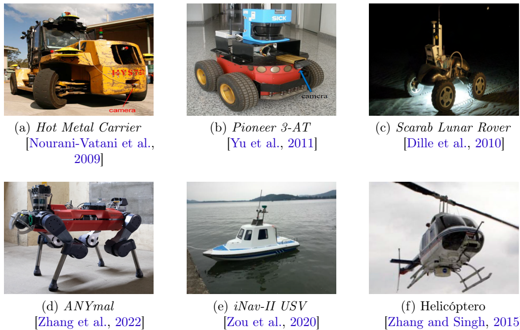
Figura 2 – Exemplos de diferentes plataformas que empregaram odometria visual para estimativa de movimento.
