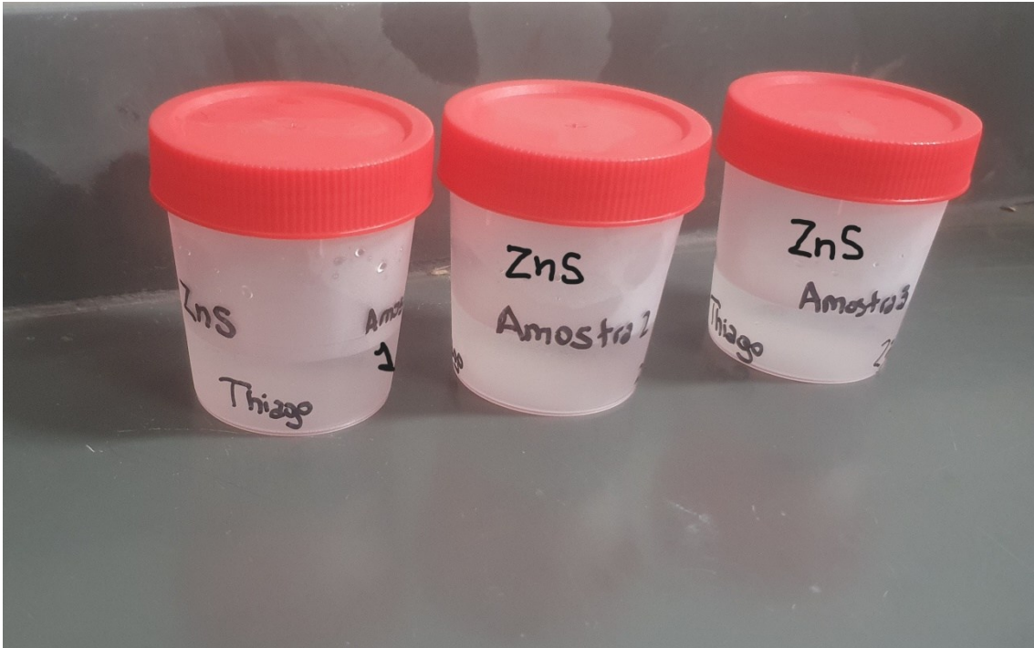
Figura 5.1.1: Pontos quânticos de ZnS sintetizados
