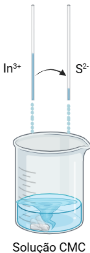
Figura 4.1.2.1: Esquema de síntese dos \text{In}_2\text{S}_3 QD's (próprio autor)
