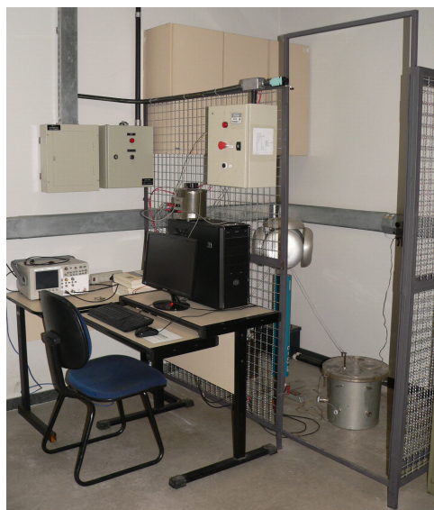
Figura 5 – Planta de medição de Descargas Parciais
